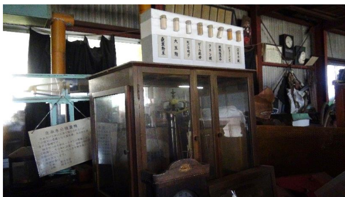
図8 棚後ろ左の機械：生糸水分検査機(検査用の糸を140°Cの熱風で乾燥して5分毎に計量し、連続2回の計量値の差がなくなった時を無水量として正量を算定する機械)、棚上のビン：人工飼料のサンプル
