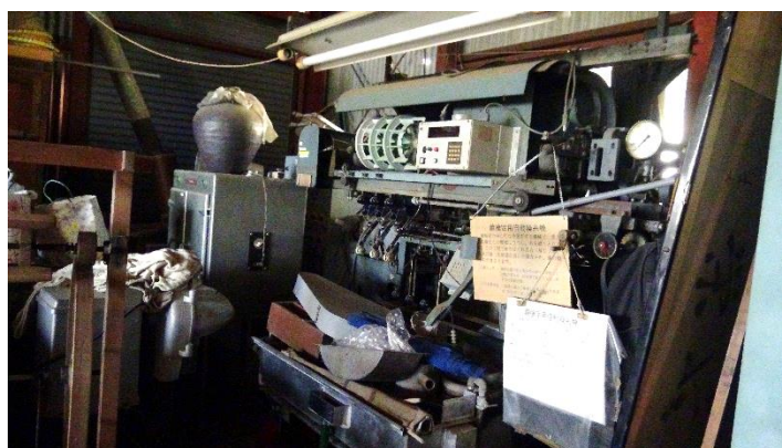
図7 繭検定用自動繰糸機(煮上がった繭をこの機械に移し糸を繰り取る工程で、解除率(糸のほぐれ具合)と生糸量歩合(生糸の量)を検定する機械)
